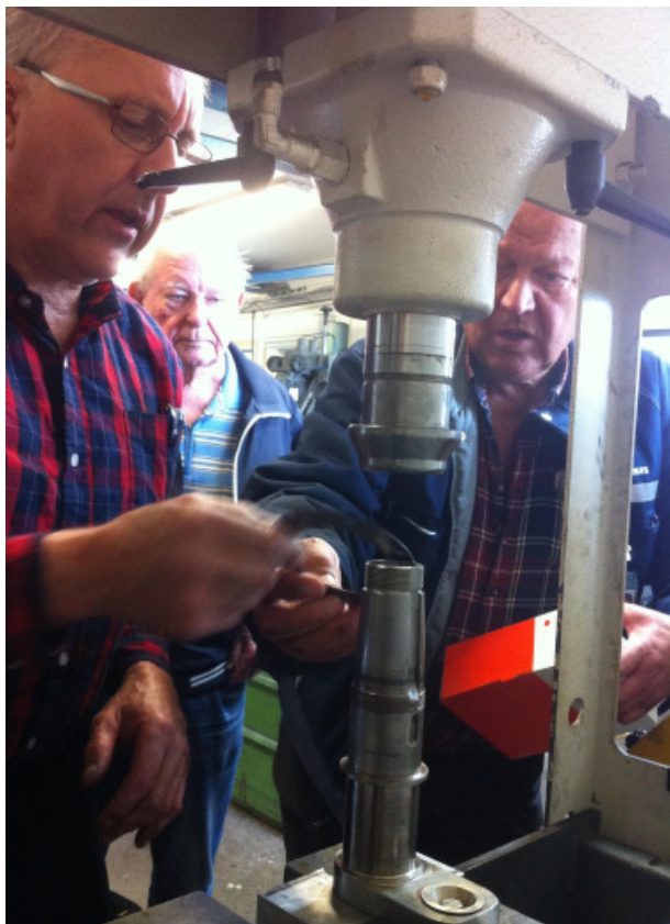
Exempel på hemarbete: Cirrusmotorns vevaxel får nytt främre lager. Fr.v. vår externa klippa, Janne Johansson, Rune och Rolf
